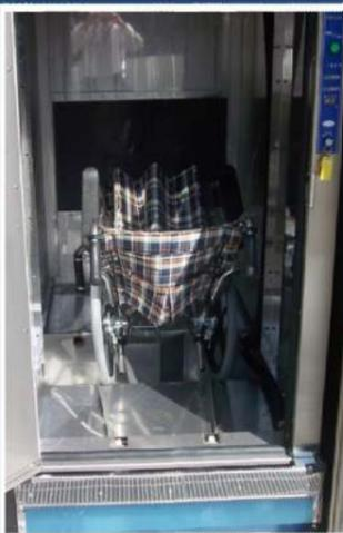
きれいで清潔な車椅子を利用して欲しいという願いから、車椅子洗浄機を導入しました。ボタンを押すだけで手の入りづらい車いすの裏側や細かい所もしっかりと洗浄してくれます。手作業に比べて、水の使用量も節約できるそうです。きれいで清潔な車椅子はご利用者、職員共に気持ちが良いです。
